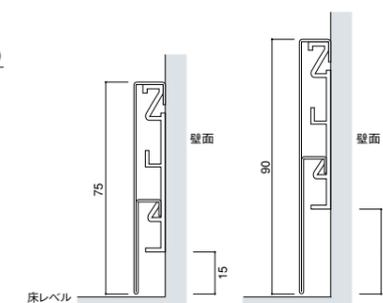
●巾木寸法 (60mm用・75mm用・90mm用) の違いにより、樹脂ベースの取付位置が異なります。上記図にしたがって施工して下さい。
