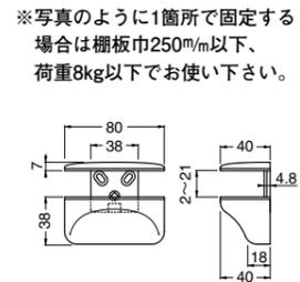
※写真のように1箇所固定する場合は棚板巾250mm以下、荷重8kg以下でお使い下さい。
