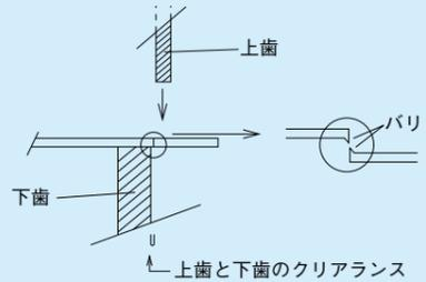
上歯が下がり材料を切断する際、上歯と下歯のクリアランスにより材料が引きちぎれる状態になりバリが発生します。
