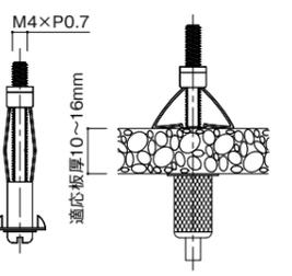
①天井ボードに4mmボードアンカーを取り付けてください。
