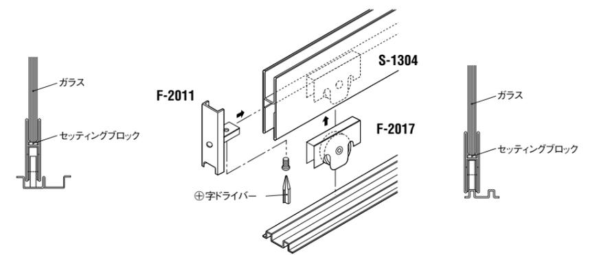
◎裏止めネジは、締金具で最後まで、きつく締め付けてください。
