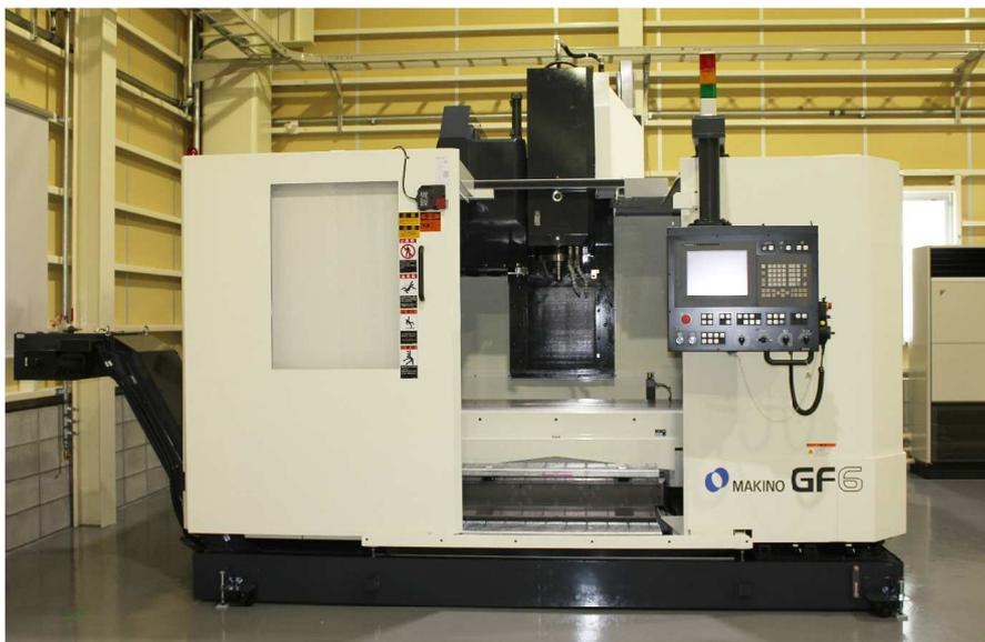
株式会社シロクマは牧野フライス製作所の立形マシニングセンタ「GF6」を8月に新築した平野新工場に導入しました。「GF6」は重切削対応で、高速加工機とは比較にならないほど主軸剛性が高い機種です。太いドリルでも気にせず使い、加工できるワークサイズは600×1050mmという大きさ。二次元的な形状の加工に向いています。剛性の高い大径エンドミルが使えるので、高速加工機では困難な深いポケットもきれいに仕上げることができます。重切削、荒取りとして使いながら精度も出せるところがポイントです。
