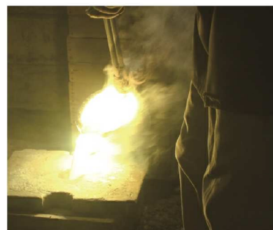
砂型に溶かした真鍮を流し込んで鋳造。熟練職人の技が冴える。
