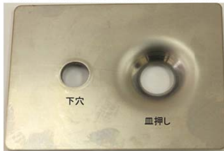
下穴+皿押し加工(M10) ※上は表面、下は裏面
