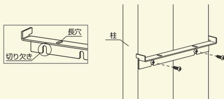
2. 棚板をブラケットにのせて、ねじで取付けます。ブラケットを取り外す時にスライドできるように長穴の端(図)に取付けて下さい。
