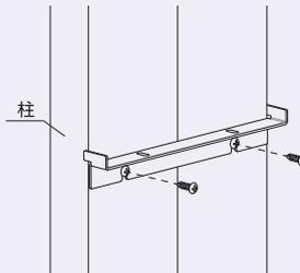
2. 棚板をブラケットにのせて、ねじで取付けます。ブラケットを取り外す時にスライドできるように長穴の端(図1)に取付けて下さい。
